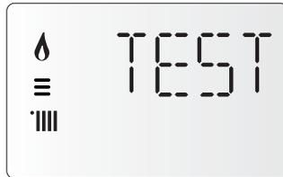
Tourner l'encodeur. Sélectionner le pictogramme :
