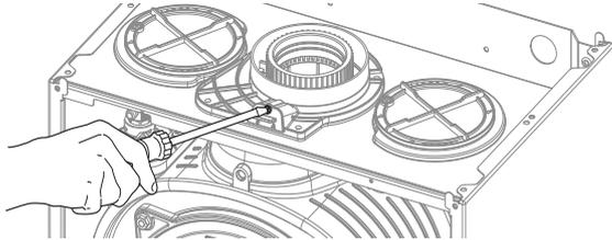
**Opération 2 Ajustement du CO2 au débit gaz maximal (sanitaire)**
