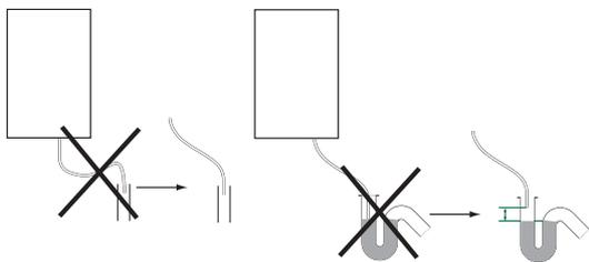
**!** Avant la première mise en route de l'appareil, il est impératif de remplir le siphon (12) de la chaudière avec de l'eau. Pour cela, verser environ 1/4 de litre d'eau par l'orifice d'évacuation des gaz brûlés avant de monter le dispositif d'évacuation ou dévisser le siphon placé sous la chaudière, le remplir d'eau et le remettre en place
